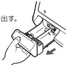
②電池ケースに表示してある ⊕ 側 ⊖ 側を確認して正しくセットする。
