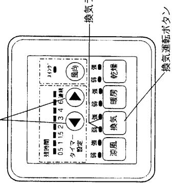
リモコンの [換気] ボタンを押すと換気強運転に、もう一度 [換気] ボタンを押すと換気弱運転に切り換わります。運転中は強または弱ランプが緑色点灯します。お好みに応じて、換気の強弱を選択してください。
