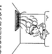
■運転中に浴室内の温度が上がるごとに、シャンプーなどのボンプ内の空気が膨張して、液体が押し出される場合があります
