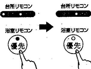
浴室リモコンと台所リモコンが設置されている場合、給湯温度が調節できるのは優先ランプが点灯しているリモコンだけです。これはやけどなどの事故を防ぐためです。
