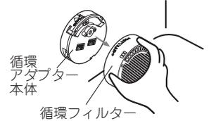
③ 循環フィルター正面と側面の裏表面をブラシなどで掃除する。
