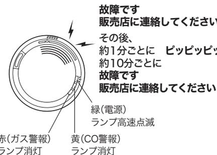
ただし、警報停止スイッチを押すと、警報音は約36時間停止します。緑(電源)ランプの高速点滅は止まりません。 ※販売店までご連絡ください。 ※外部機器と連動している場合、警報音停止中は外部機器の連動動作は停止します。
