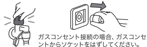
ガスコンセント接続の場合、ガスコンセントからソケットをはずしてください。
