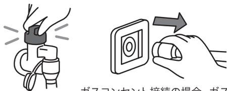
ガスコンセント接続の場合、ガスコンセントからソケットをはずしてください。
