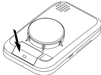
**警告** 警報器を設置する前は、確実に起動プラグを抜き、スイッチを押して動作の確認を行ってください。電源が投入されなかった場合は、警報器が作動せず、音声警報が鳴りません。
