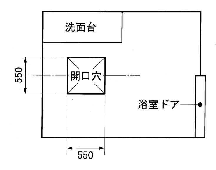
●洗面台を使用する際に、人が立つ後側に 天井開口穴位置を決めてください。 (550×550 mm)
