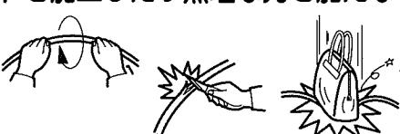
電源コードを傷つけたり、挟み込んだり、加工したり、ねじったり、無理に曲げたり、たばねたりしますと、電源コードが破損し、火災・感電の原因になります。
