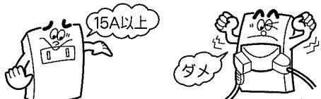
他の機器と併用する分岐コンセントなどを使用しますと、過熱・発火・火災の原因になります。
