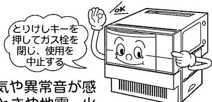
異常な臭気や異常音が感じられたときや地震・火災のときは「とりけしキー」を押して使用を中止しガス栓を閉じてください。そのまま運転しますと故障や感電、火災の原因になります。
