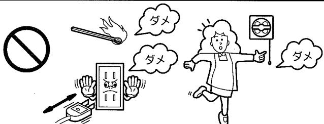
ガス供給業者の処置が終わるまでは、絶対に火をつけたり、電気器具のスイッチの「入・切」や電源プラグの抜き差し、周辺の電話を使用しないでください。
