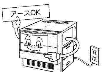
取り付けないで使用すると、故障や漏電のときに、感電する恐れがあります。
