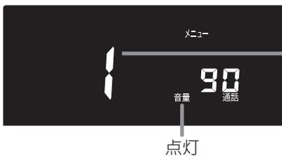
確定スイッチを押すと点灯に切り替わり確定します。その後、通話画面に戻ります。
