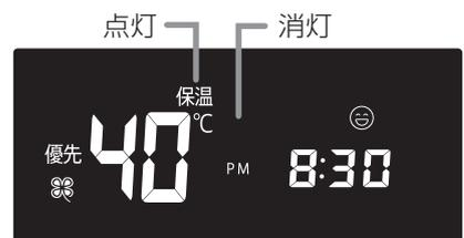
※確定スイッチやふろ予約スイッチを押さずに、そのまま約3分間放置すると、そのときの時刻で自動的に時刻設定が完了します。（時「—」は未設定で確定、分「—」は00分で確定します。）
