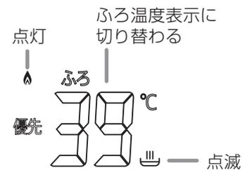
・給湯優先に設定している場合、ふろ温度を表示し、3秒後に給湯温度表示に切り替わります。
