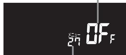
点滅 確定スイッチを押すと点灯に切り替わります。
