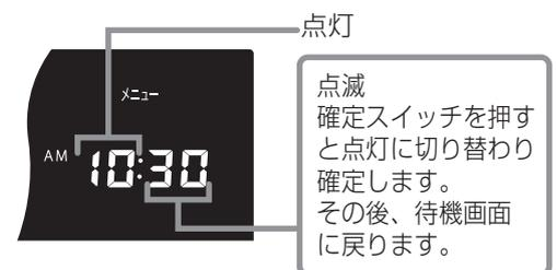
※確定スイッチを押さずに、そのまま約3分間放置すると、そのときの設定内容で自動的に設定が完了します。
