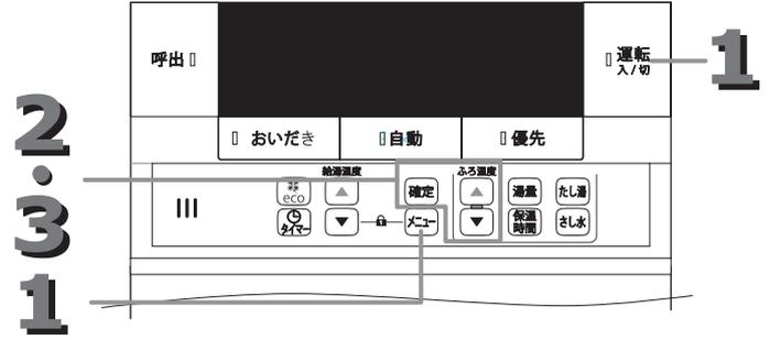
**1** 運転スイッチを押し、運転ランプの点灯を確認し、メニュースイッチを押す
