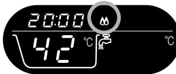
設定温度が点滅中に「あつめ(おいだき)」スイッチを押すごとに、プラス1℃→プラス2℃→プラス3℃→切と温度を調節できます。
