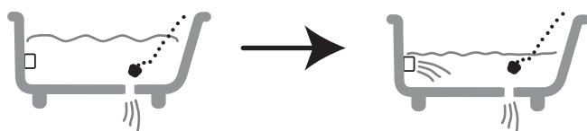
※自動運転が完了した後、24時間を超えてから浴槽内の湯を抜いても配管クリーン機能は行われません。
