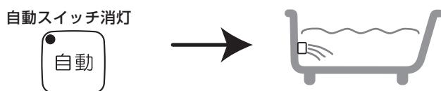
※自動運転が完了すると、浴槽にお湯が残った状態でも配管クリーン機能が行われます。
