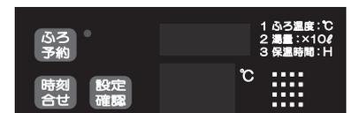
※ふろ予約スイッチを押さずに、そのまま約3分経過するとそのときの設定内容で自動的に設定が完了します。
