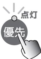
給湯リモコンとふろリモコンはそれぞれが優先権を持っていたときに設定した給湯温度を記憶しています。優先権が切り替わると優先権を持つリモコンが記憶していた給湯温度になります。
