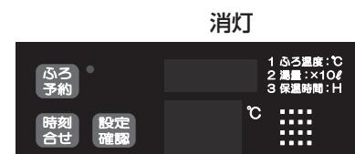
※ふろ予約スイッチを押さずに、そのまま約3分経過するとそのときの設定内容で自動的に設定が完了します。
