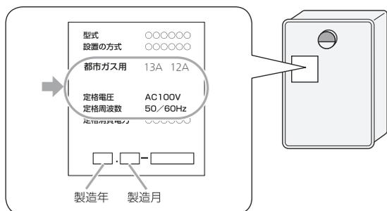
表示のガス種および電源が一致しないと、不完全燃焼による一酸化炭素中毒になったり、異常点火でやけどしたり、機器が故障する場合があります。
