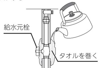
給水元栓が回るようになれば解凍できたので、台所などの給湯栓を閉めてください。
