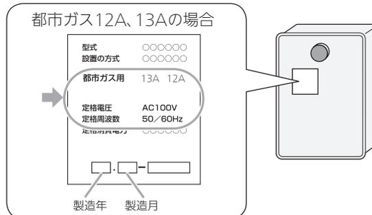
表示のガス種および電源が一致しないと、不完全燃焼による一酸化炭素中毒になったり、異常点火でやけどしたり、機器が故障する場合があります。
