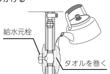
給水栓が回るようになれば解凍できたので、台所などの給湯栓を閉めてください。
