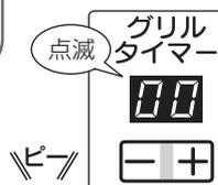
ブザー音『ピー』とタイマー表示部点滅でお知らせしたあと、タイマー表示部が消灯します。
