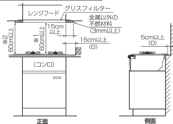
※（ ）内は、周囲の壁が不燃材料で有効に仕上げた部分もしくは、防熱板を取り付けたときの寸法です。
