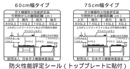
防火性能評定シール( トッププレートに貼付 )
