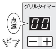
ブザー音『ピー』とタイマー表示部点滅でお知らせした後、タイマー表示部が消灯します。
