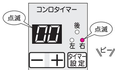
ブザー音『ピー』とタイマー表示とランプの点滅でお知らせした後、消灯します。
