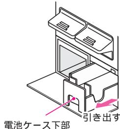
4 単1形アルカリ乾電池 (2個) の $\oplus$  $\ominus$ を確かめ、電池ケースに組み込む。
