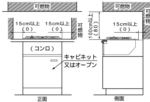
上記離隔距離がとれない場合は、必ず防熱板による防火措置を行ってください。
