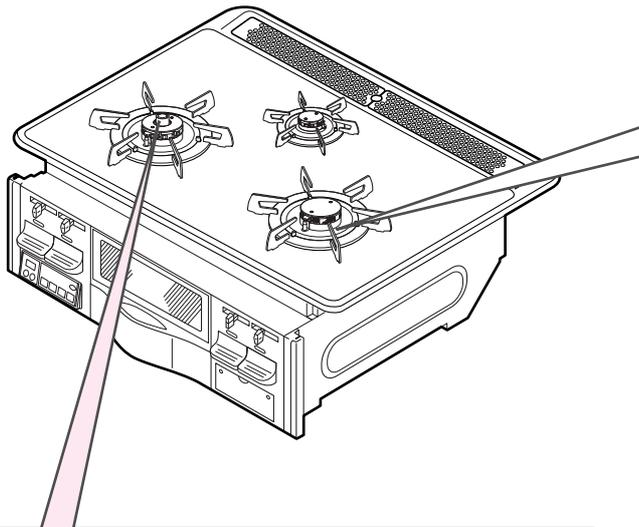
温度センサー・点火プラグ・立消え安全装置
