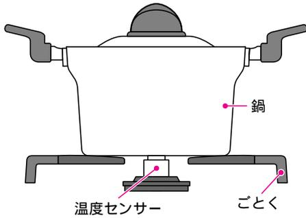
温度センサーの上面に異物がないことを確認し、鍋底の中心が温度センサーに密着するように正しくセットしてください。
