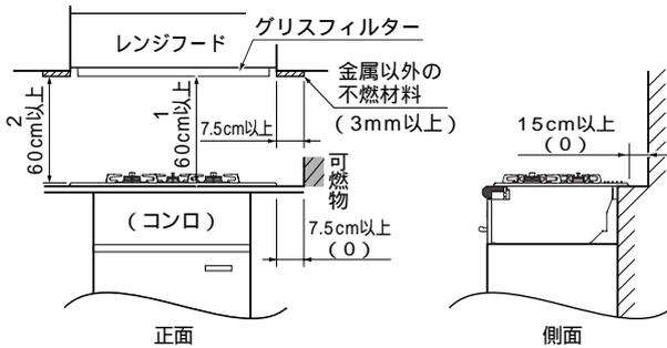
( )内は、周囲の壁が不燃材料で有効に仕上げた部分もしくは、防熱板を取り付けたときの寸法です。
