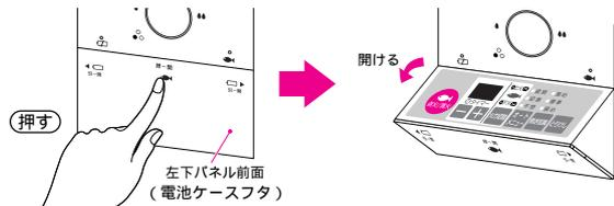
2. ①電池ケースフタの左右側面の凹部を指で引っかけて、矢印の方向に開ける。
