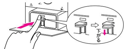
6. ●左下パネルの前面上部を押し、電池ケースフタを元どおりに閉じる。
