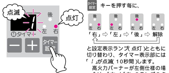
と設定表示ランプ(点灯)とともに切り替わり、タイマー表示部には「!」が点滅(10秒間)します。高火力バーナーが左側仕様の場合は、「右」と「左」のランプの点灯順が逆になります。
