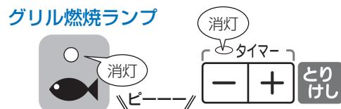
ブザー音「ピ――」と天面液晶表示の点滅でお知らせした後、約30秒経過すると、消灯します。
