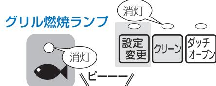
ブザー音『ピーーー』とお知らせした後、天面液晶表示部が消灯します。
