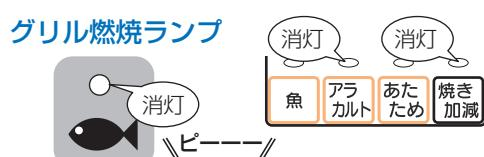
ブザー音「ピ---」と天面液晶表示部の点滅でお知らせした後、約30秒経過すると、消灯します。
