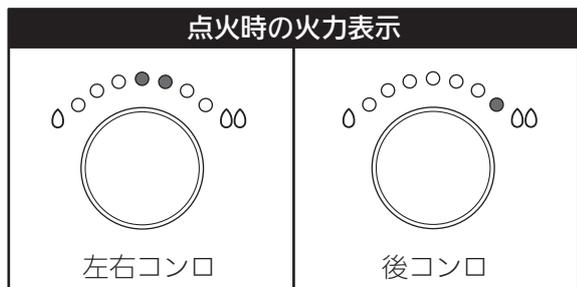
※安全のため、高火力コンロは火力8(火力表示4・5点灯)で点火します。
