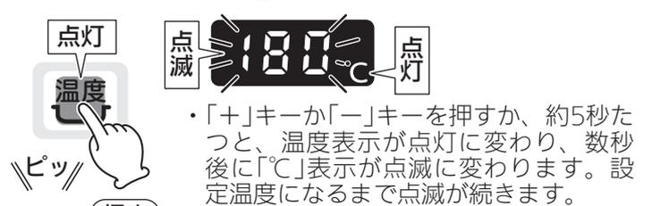
・「+」キーか「-」キーを押すか、約5秒たつと、温度表示が点滅になり、数秒後に「°C」表示が点滅になります。設定温度になるまで点滅が続きます。
