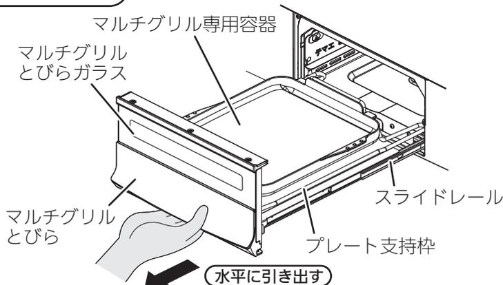
② マルチグリル専用容器、プレート支持枠の順に、一つずつ持ち上げて取り外してください。
