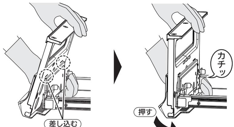
マルチグリルとびらの溝部(左右2カ所)に、スライドレールの凸部(左右2カ所)を差し込む。
