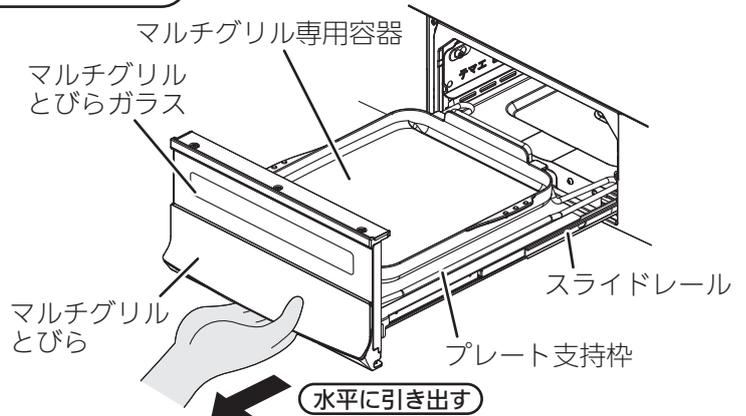
② マルチグリル専用容器、プレート支持枠の順に、一つずつ持ち上げて取り外してください。
