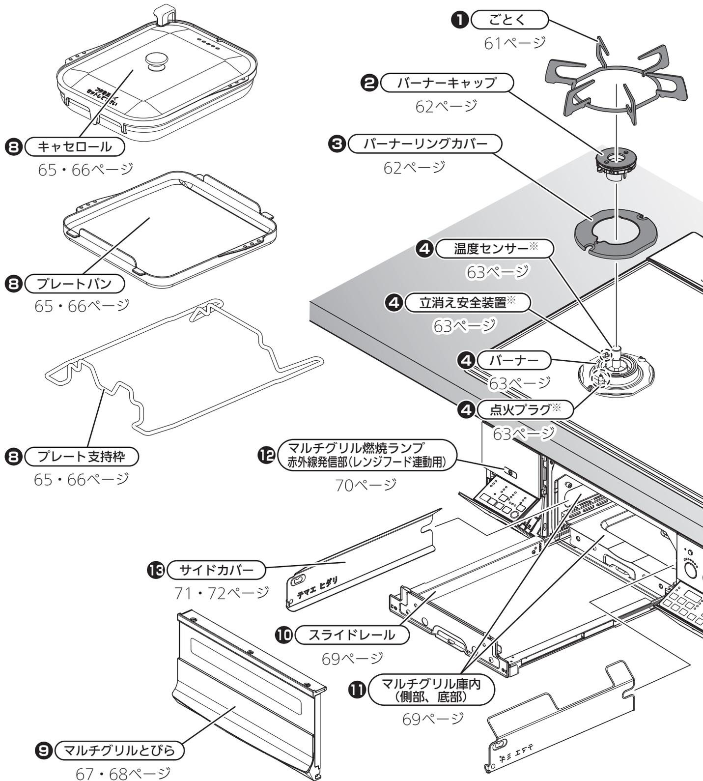
※温度センサー、点火プラグ、立消え安全装置は、すべてのコンロバーナーに付いています。
