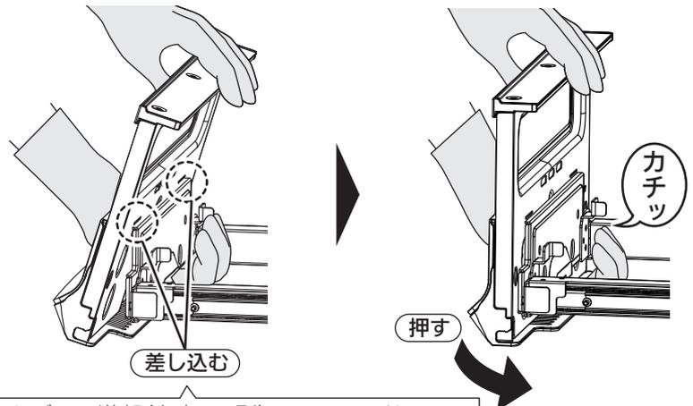
マルチグリルとびらの溝部(左右2カ所)に、スライドレールの凸部(左右2カ所)を差し込む。
