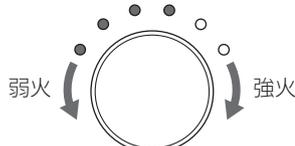
※火力は中火以上で鍋の径に応じて炎があふれない程度に調節してください。火力を弱火で使用しますと、温度調節機能が正しくはたらかしません。
