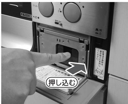
※電池ケースを奥まで押し込んでいない状態で、右操作部ふたを閉めないでください。右操作部ふたが、破損する原因になります。
