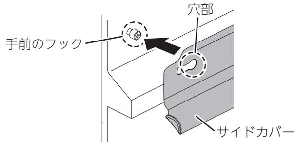
②左手でサイドカバーの指かけ部を持ち、右手でサイドカバー側面を押さえ、まっすぐ奥に押し込みながら、奥のフックにサイドカバーの切り欠き部を差し込んでください。
