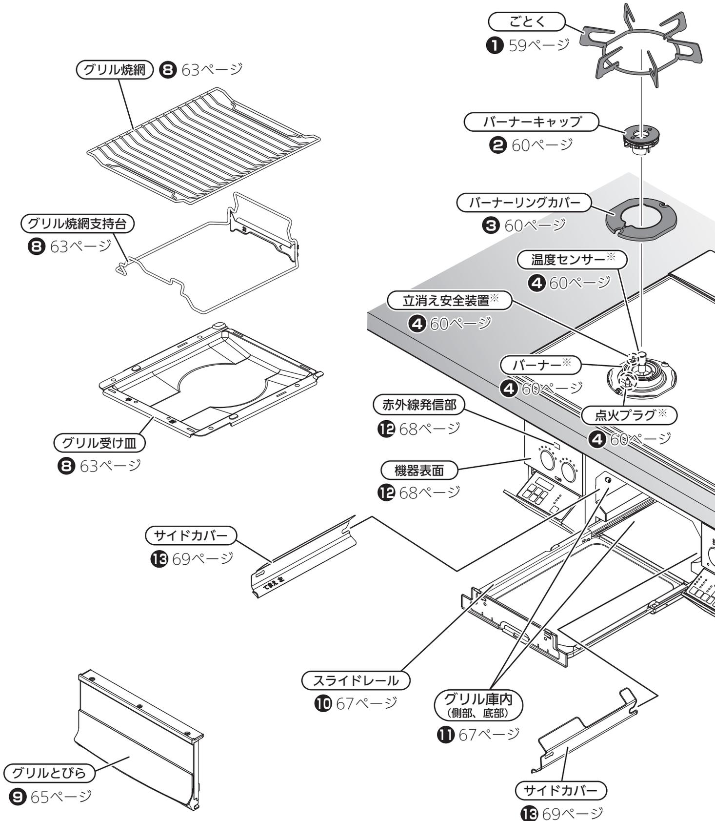
※バーナー、温度センサー、点火プラグ、立消え安全装置は、すべてのコンロバーナーに付いています。
