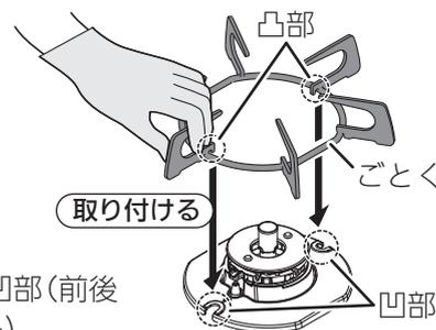
**取り付けかた** ・ごとく内側の凸部(前後2カ所)を、バーナーリングの凹部(前後2カ所)に入れて、浮きがないように取り付けてください。
