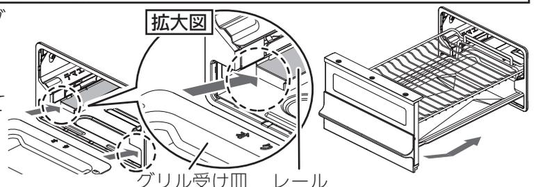
グリルとびらが閉まりにくい場合やこすれる音がした場合は、サイドカバー、グリルとびら、グリル受け皿、グリル焼網支持台、グリル焼網が正しく取り付けられていません。そのまま押し込むと、変形や損傷の原因になりますので、再度正しく取り付け直してください。
