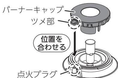
・バーナーキャップのツメ部が、点火プラグの真上にくるように合わせ、浮きがないように取り付けてください。(点火プラグに衝撃をあたえないようにしてください。)
