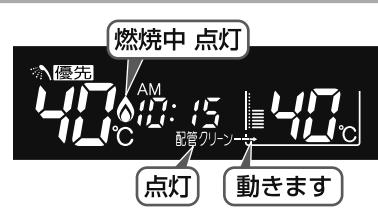
機器がふろ設定温度のお湯を約7L流して、ふろ配管内の残り湯を押し出し、自動的に止まります。
