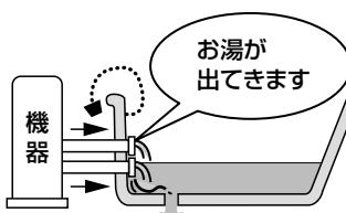
機器がふろ設定温度のお湯を約7L流して、ふろ配管内の残り湯を押し出し、自動的に止まります。
