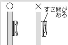
フィルターを外したまま、または、正常に取り付けられていない状態で使用すると、機器が故障することがありますので、必ず正常に取り付けた状態で使用してください。
