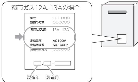
表示のガス種および電源が一致しないと、不完全燃焼による一酸化炭素中毒になったり、異常点火でやけどしたり、機器が故障する場合があります。
