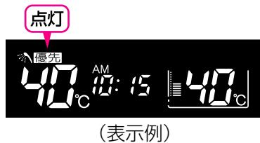
\* 浴室リモコンで記憶していた給湯温度を表示します。
