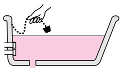
※市販または洗濯機付属のふろ水ポンプなどで洗濯用にくみ上げて残り湯が減った場合は、機器が排水を検知できないため、ふろ配管クリーンが作動しない場合があります。
