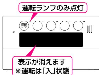
\*お湯使ったりスイッチを押すと、「表示の節電」を解除します。
