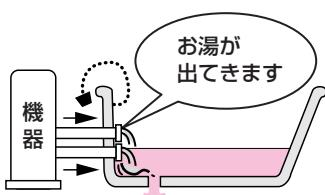
機器がふろ設定温度のお湯を約7L流して、ふろ配管内の残り湯を押し出します。
