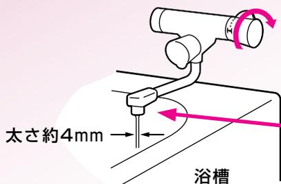
\*機器だけでなく、給水・給湯配管、給水元栓なども同時に凍結予防できます。
