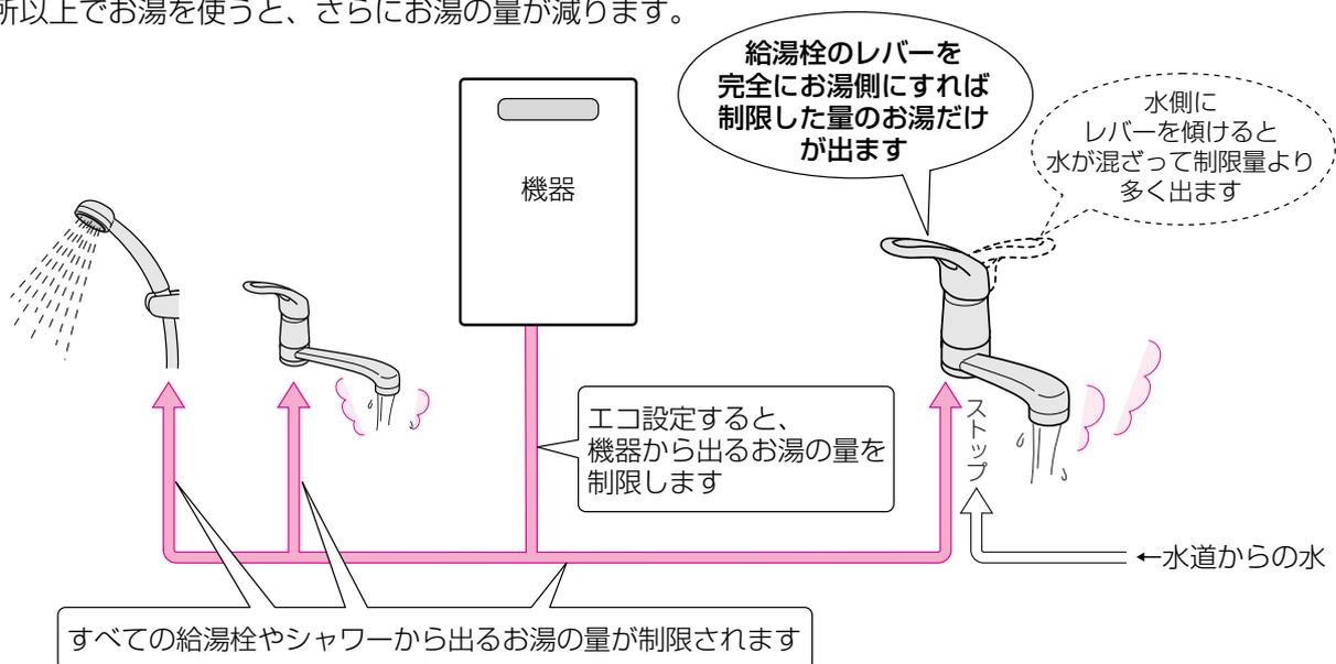
\*停電したり電源プラグを抜くと、エコ設定は解除されます。(給湯量の設定は変わりません)
