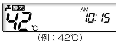
\* **優先** (浴室リモコンの場合 **優先**) が点灯していない場合に **給湯温度** を押すと、「ピピピ」と鳴って温度調節ができないことをお知らせします。
