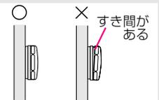
フィルターを外したまま、または、正常に取り付けられていない状態で使用すると、機器が故障することがありますので、必ず正常に取り付けた状態で使用してください。
