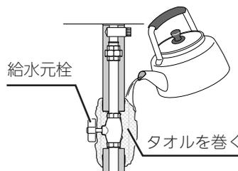
給水元栓が回るようになれば解凍できたので、台所などの給湯栓を閉めてください。
