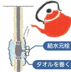
給水元栓が回るようになれば解凍できたので、台所などの給湯栓を閉めてください。
