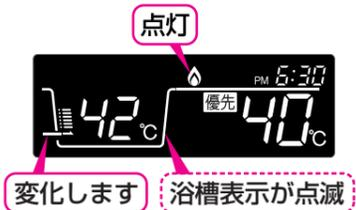
機器がふろ設定温度のお湯を約7L流して、ふろ配管内の残り湯を押し出します。
