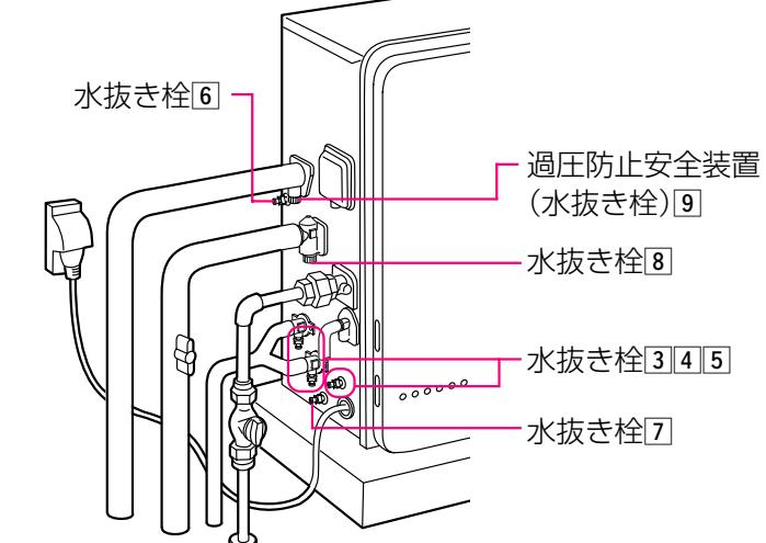
水抜き栓、過圧防止安全装置(水抜き栓)はこんな形をしています。
