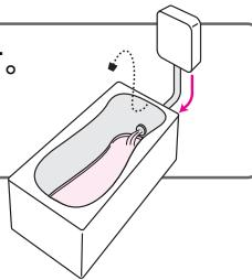
排水栓を抜くだけで、自動ふろ配管クリーンは作動します。ただし、自動ふろ配管クリーンが作動する条件があります。
