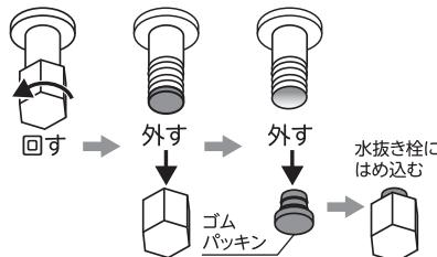
※水抜き栓の位置は、□水抜き栓位置図（→P.11）をご覧ください。
