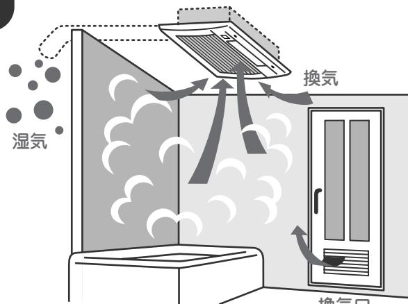
室外の空気を給気し、浴室から換気することで住戸全体の換気を補います。
