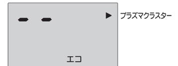
「残り時間」に「--」と表示されます。約6時間送風+換気運転でゆっくり乾燥させた後、温風+換気で仕上げて自動で停止します。残り時間が確定すると時間が表示されます。
