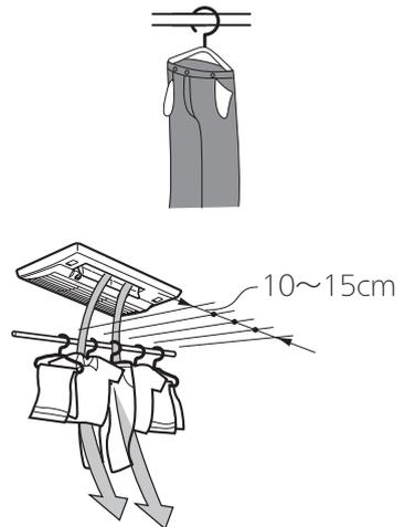
■機器の温風は洗濯物の方向に出るようにリモコンで温風吹出口（ルーバー）を調節してください。
