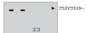
「残り時間」に「--」と表示されます。約6時間送風運転でゆっくり乾燥させた後、温風で仕上げて自動で停止します。残り時間が確定すると時間が表示されます。
