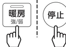
※フィルター掃除ランプが消灯した状態で上記操作を行うと、フィルター掃除ランプが点滅し、お知らせまでの時間をリセットすることができます。
