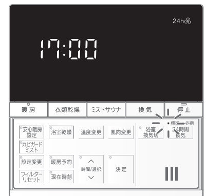
(脱衣室リモコン)
