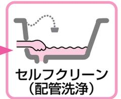
浴槽から排水すると配管内の残り湯を新しいお湯で押し流します。
