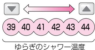
※給湯設定温度が上記以外のときに**ゆらぎのシャワー**を押すと、設定温度が35℃・37℃・38℃のときには39℃、45℃以上のときには44℃のゆらぎのシャワーになります。
