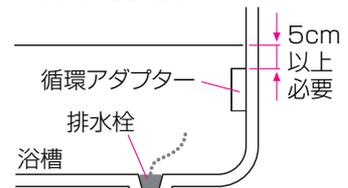
●**自動** を「切」にするとしばらくポンプが回ります。浴槽の排水栓を抜くのは「切」にして1分以上経過後(ポンプ停止後)にしてください。
