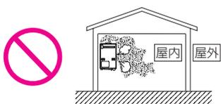
※71～82ページの「主な仕様・能力表」の設置方式欄に「屋内壁掛設置」と記載しているもの以外は屋外用です。
