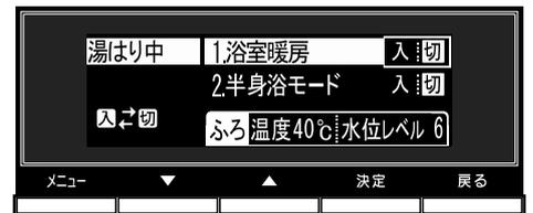
● 湯はり中のふろ設定温度と湯量（水位）を表示します。
