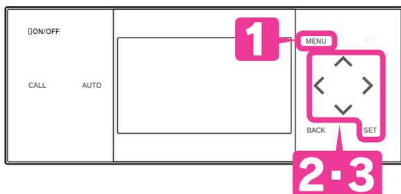
ON/OFFスイッチが「OFF」のときは押して「ON」にしてください。
