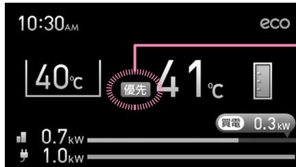
給湯温度が設定できるリモコンに表示します
