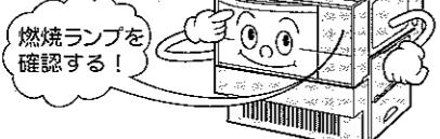
ガスオーブン使用時は、燃焼ランプの点灯で点火を確かめ、使用後は燃焼ランプの消灯で消火していることを確かめてください。
