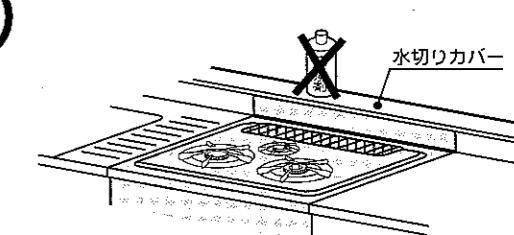
水切りカバーのある場合は、水切りカバーの上に物を置かないでください。水切りカバー表面は、熱くなりますので、置いた物が焦げたり変形することがあります。
