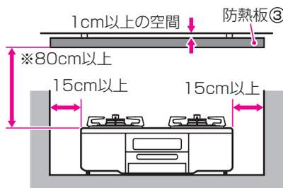
※印の寸法はトッププレート面より上方の寸法をさす。
