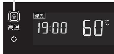
※給湯設定温度を 60°C に設定すると、音声で『熱いお湯が出ます』『給湯温度を 60°C に設定しました』とお知らせして、[高温ランプ] が点灯し、注意を促します。
