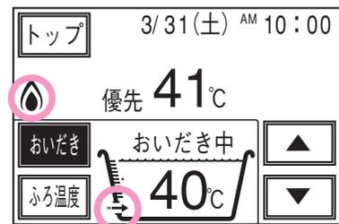
※台所リモコンで操作した場合は、約1分間ポンプ運転した後、ふる設定温度までおいだきします。なお、ふる温度がふる設定温度以上の場合は、約1分間ポンプ運転後に停止します。
