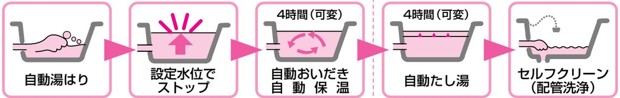
ふろ設定温度で、設定水位まで自動湯はり。残り湯があるときでも、設定水位まで自動湯はり。
