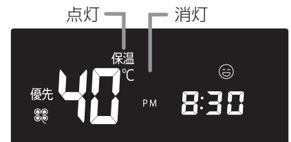
※確定スイッチやふろ予約スイッチを押さずに、そのまま約3分間放置すると、そのときの時刻で自動的に時刻設定が完了します。（時「—」は未設定で確定、分「—」は00分で確定します。）
