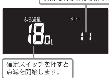
**3 給湯温度選択スイッチを押し、ふろ湯量を調節する**
