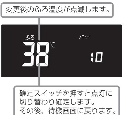
※確定スイッチを押さずに、そのまま約3分間放置すると、そのときの設定内容で自動的に設定が完了します。
