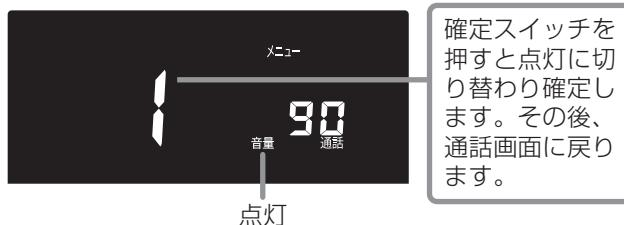
※確定スイッチを押さずに、そのまま約3分間放置すると、そのときの設定内容で自動的に設定が完了します。
