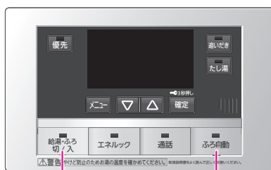
浴室リモコン
